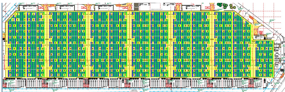
Implantation projetée des panneaux photovoltaïques
